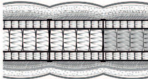
In dieser Zone befindet sich ein spezieller Drell, eine weichere Grobpolsterschicht und elastischere Federn für einen ergonomischen Komfort im Schulterbereich.
