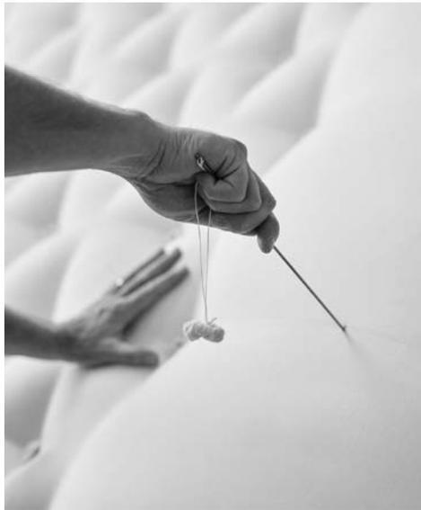
Bei Vispring tuften wir jede Matratze von Hand. Die gleichmäßig über die gesamte Matratze verteilten Tufts fixieren die Füllungen in ihrer Position. Sie werden in sorgfältig abgemessenen Abständen angebracht und bilden schließlich die üppige, charakteristisch konturierte Oberfläche unserer Matratzen. Durch das Handtufting bleibt alles sicher an Ort und Stelle und gewährleistet Ihren Komfort – 30 Jahre lang oder länger.
